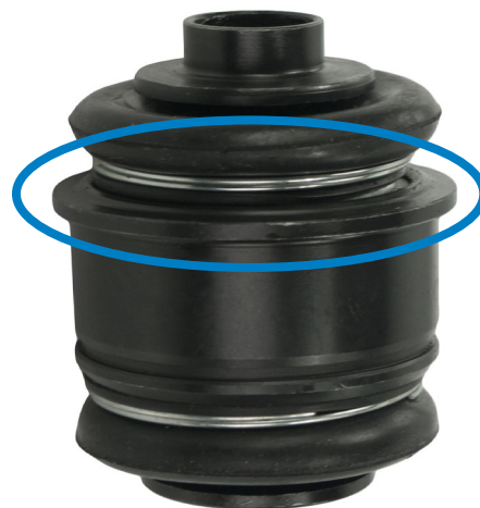
Figure 2. S'assurer que le bord (encerclé) est orienté correctement lors de l'installation.
