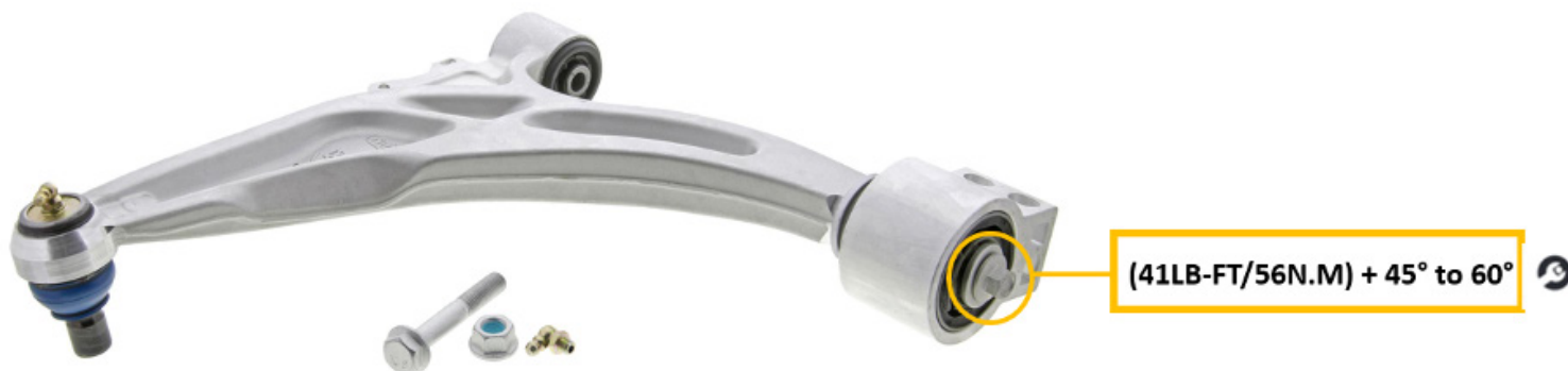
Figure 1. Le boulon de support de bague (encerclé ci-dessus) doit être serré correctement après l'installation du bras de suspension sur le véhicule.
