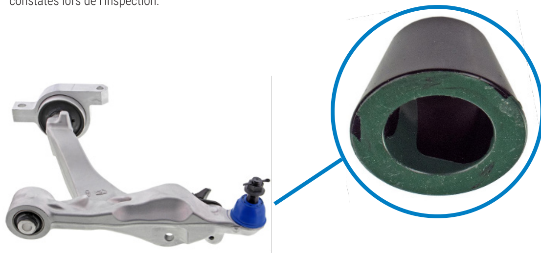
Figure 1. Cône d'appui de joint à rotule typique de Nissan et Infiniti (encerclé). Ce cône peut se gripper sur le goujon du joint à rotule et présenter une différence visuelle par rapport au bras de suspension de rechange.
