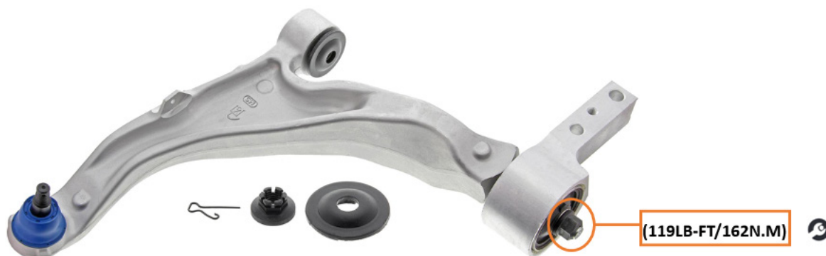
Figure 1. L'écrou de support de bague (encerclé ci-dessus) doit être serré correctement après l'installation du bras de suspension sur le véhicule
