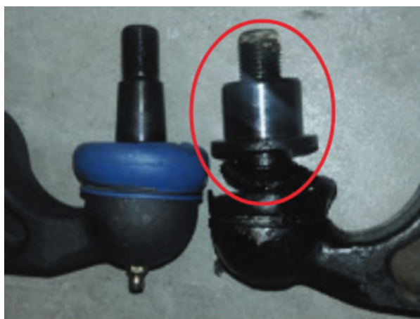
Figure 1. Bras de suspension d'origine avec l'insert saisi sur le goujon (encerclé en rouge).
