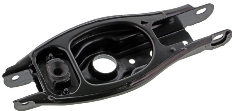
Figure 1. Bras de suspension inférieur arrière standard d'une série autre que la série M fabriqué en acier estampé
