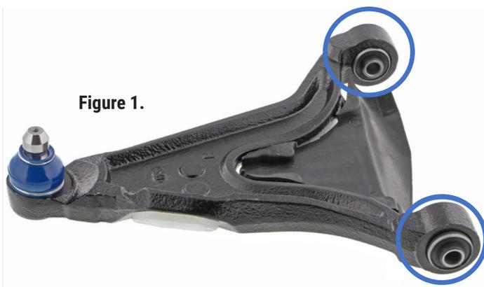
**Figure 1.** Type 1 – Communément appelé « style à 2 boulons », car 2 boulons de bagues au cadre sont nécessaires.
