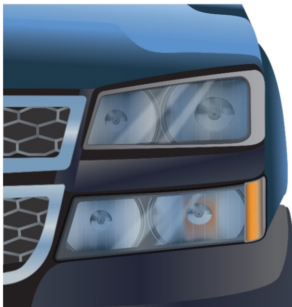
Figure 1. Phare en deux pièces de camion GMT 800 « Classic ». La conception divisée est une caractéristique distinctive.
