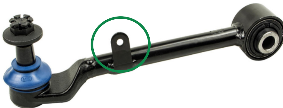
Figure 1. Les pièces CMS601029 et CMS601030 sont dotées d'une languette de montage pour les capteurs de hauteur de conduite arrière des véhicules équipés d'une suspension ADS. Cette languette n'est pas requise pour l'installation du bras de suspension sur les véhicules équipés d'une suspension de base.
