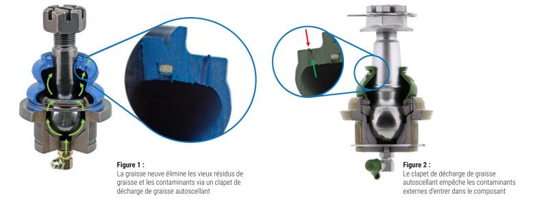
Les composants de direction et de suspension Mevotech Supreme et TTX sont prégraissés lors de leur fabrication. Cependant, il est suggéré d'introduire un ou deux coups de pompe de graissage lors de l'installation. Après l'installation, il est recommandé d'inspecter et de graisser à nouveau à chaque intervalle d'entretien de l'huile du véhicule.
