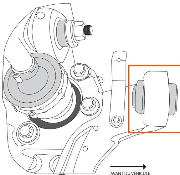
**Figure 1.** Emplacement de la bague transversale sur la fusée arrière.
