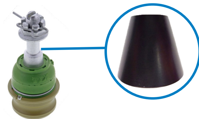
Figure 1. Le logement conique de la rotule (encadré) peut gripper le pivot du joint à rotule, lui donnant une apparence différente de celle de la pièce de Mevotech. Les joints à rotule de rechange Mevotech TXK9513/MK9513/GK9513 comportent un pivot à rotule recouvert d'un agent anticorrosion pour réduire le risque de grippage.
