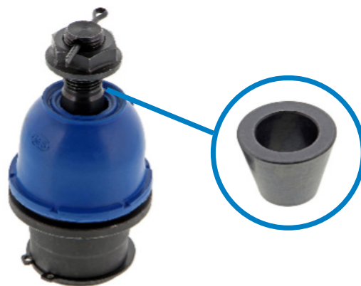
Figure 1. Le manchon conique (encerclé) peut se gripper sur le goujon du joint à rotule et présenter une différence visuelle par rapport à la pièce de rechange neuve. Le joint à rotule Mevotech Supreme MS30506 comprend un revêtement anticorrosion pour réduire les risques de grippage.
