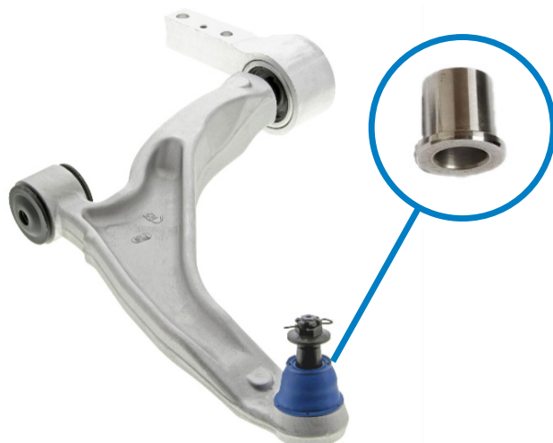
Figure 1. Le manchon de porte-fusée de direction (encerclé) peut se gripper sur le pivot du joint à rotule et présenter une différence visuelle par rapport à la pièce de rechange neuve. Les ensembles de bras de suspension Mevotech Supreme comprennent un pivot à rotule revêtu d'un traitement anticorrosion pour réduire les risques de grippage.
