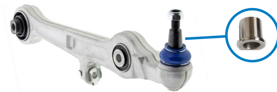
Figure 1. Le manchon conique du porte-fusée de direction (encerclé) peut se gripper sur le pivot du joint à rotule et présenter une différence visuelle par rapport à la pièce de rechange neuve. Les ensembles de bras de suspension Mevotech Supreme comprennent un pivot à rotule revêtu d'un traitement anticorrosion pour réduire les risques de grippage.
