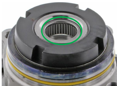
Figure 1. Lubrifier les roulements à aiguilles avant de les installer.
