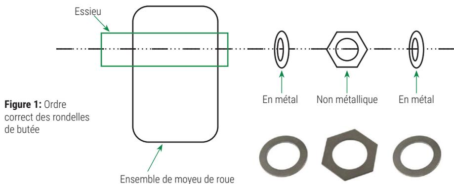
**Figure 1:** Ordre correct des rondelles de butée
