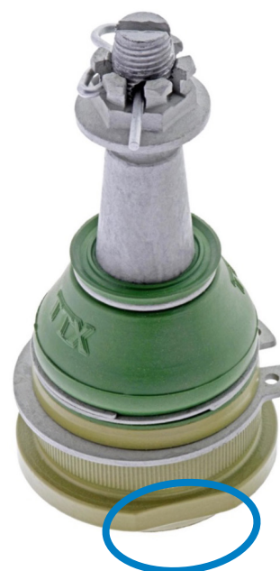
Figure 2. Surface plate usinée sur le joint à rotule (encerclée)
