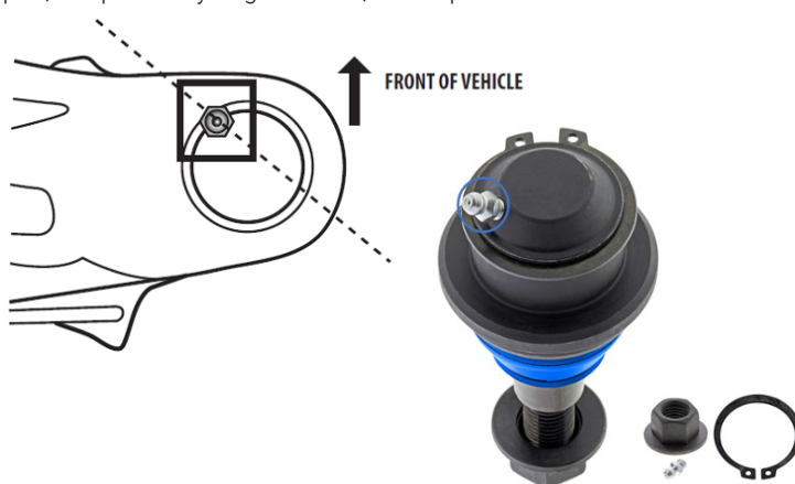
Figure 1. Pour assurer un dégagement adéquat entre les composants lors des entretiens de lubrification, le joint à rotule doit être installé tout en orientant le raccord de graissage selon un angle d'environ 45 degrés vers la ligne médiane du véhicule.
