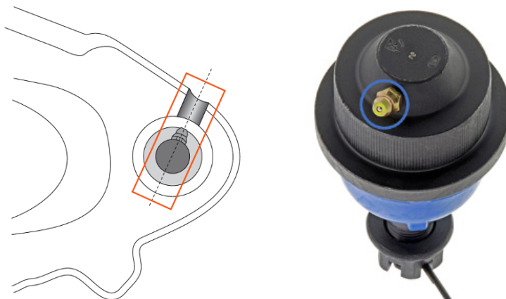
Figure 1. Pour assurer un dégagement adéquat entre les composants et permettre une accessibilité lors des prochains entretiens de lubrification, le joint à rotule doit être installé en prenant soin d'aligner le raccord de graissage à la rainure sur le bras de suspension inférieur avant.
