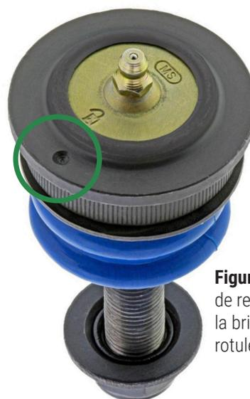
Figure 2. Marque de repère forée sur la bride du joint à rotule (encerclée)
