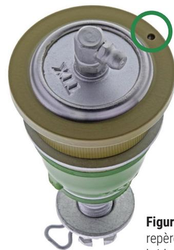
Figure 2. Marque de repère forée sur la bride du joint à rotule (encerclée)
