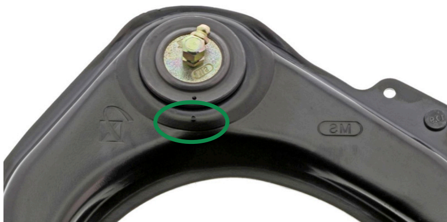
Figure 2. Repère du bras de suspension. Dans cet exemple, le repère est un trou.
