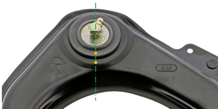
Figure 3. L'orientation correcte de l'installation est obtenue lorsque le repère du joint à rotule aligné avec le repère du côté du bras de suspension.
