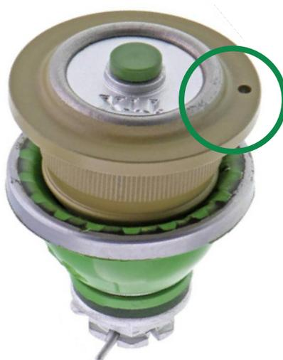
**Figure 1.** Repère du joint à rotule. Dans cet exemple, le repère est un trou.
