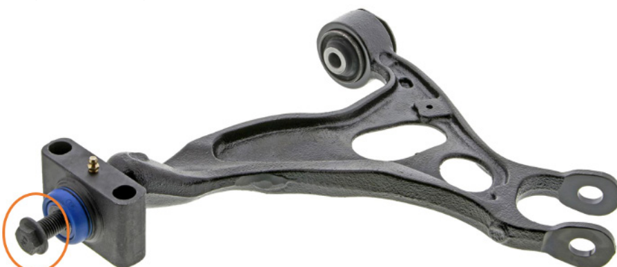
Figure 1. Le boulon de bague (encerclé plus haut) doit être serré correctement après l'installation du bras de suspension sur le véhicule.
