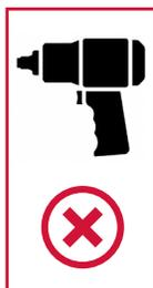
1. Resserrer l'écrou de joint à rotule inférieur à 200 N·m (148 lb·pi)
