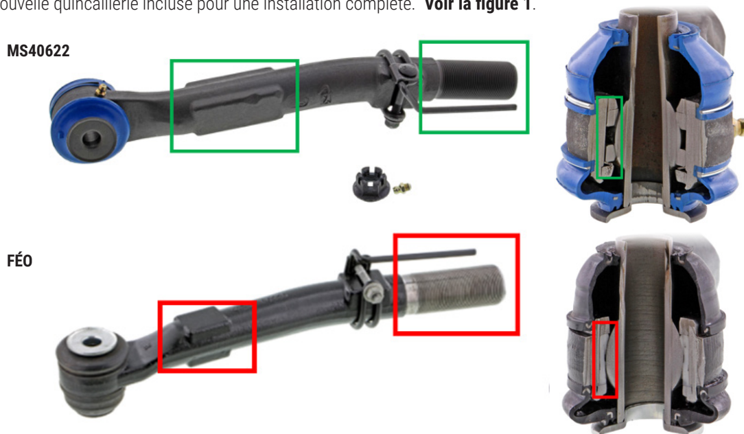
Figure 1. Embout de biellette de direction extérieur avant droit Mevotech Supreme MS40622 présentant un profil de forgeage amélioré, des paliers supérieurs et inférieurs frittés autolubrifiants et graissables et un revêtement anticorrosion complet ainsi que la quincaillerie incluse (haut) par rapport à la pièce d'origine présentant un palier en plastique scellé, un profil de forgeage réduit et un embout fileté sans revêtement (bas).
