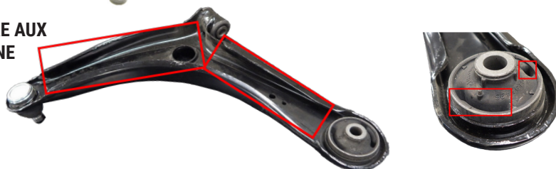
Figure 1. Bras de suspension inférieur avant Mevotech Supreme CMS80170 présentant un profil d'estampage amélioré avec une plaque de renforcement et des cavités de bagues remplies (haut) comparativement à la conception d'origine (bas)
