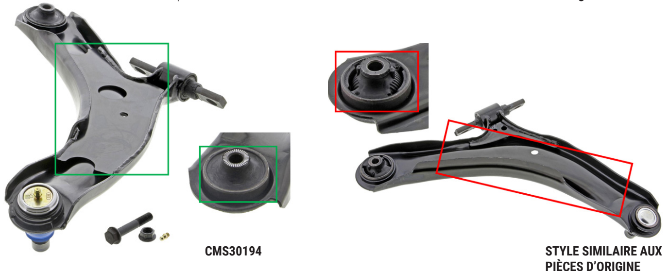
Figure 1. Bras de suspension inférieur avant CMS30194 de Mevotech Supreme présentant un profil d'estampage amélioré avec une plaque de renforcement et des cavités de bagues remplies (gauche) comparativement à la conception d'origine (droite)
