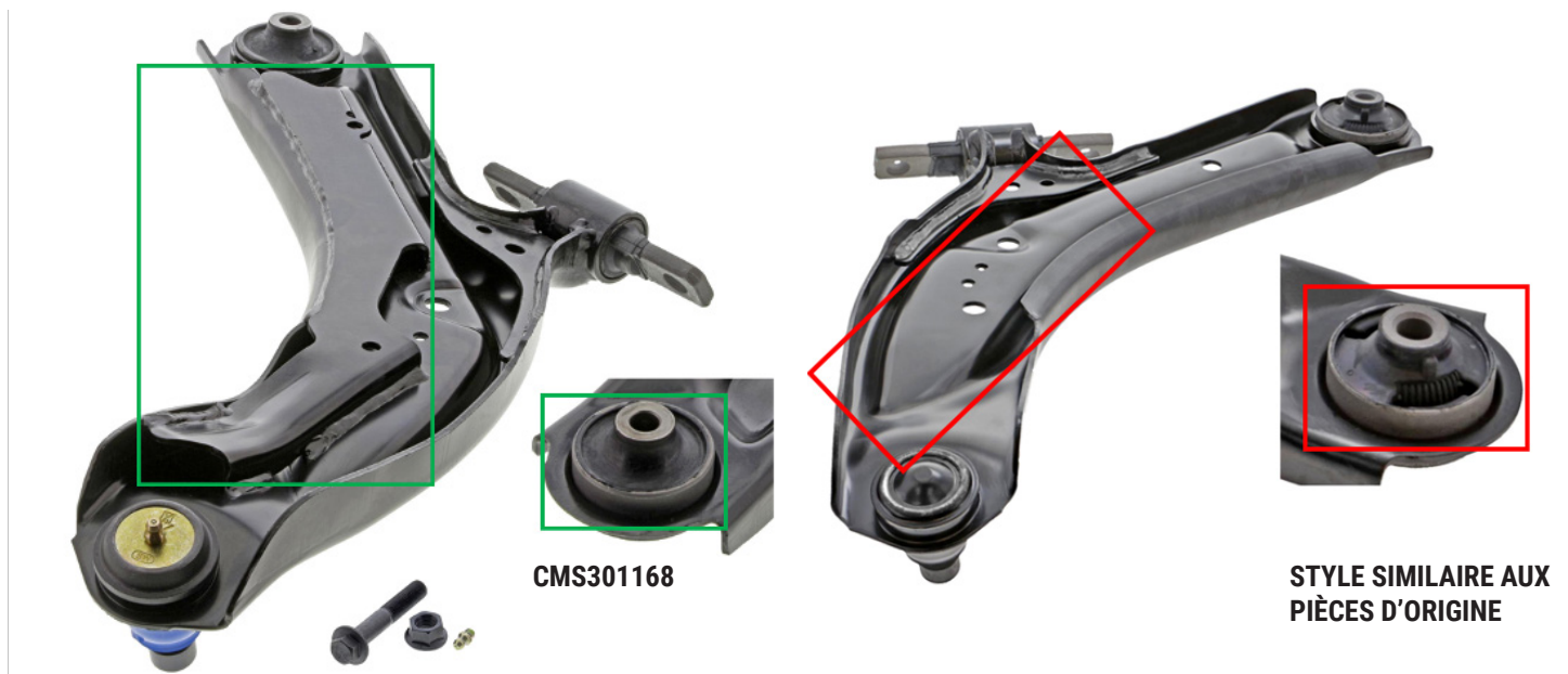
Figure 1. Bras de suspension inférieur avant CMS301168 de Mevotech Supreme présentant un profil d'estampage amélioré avec une plaque de renforcement et des cavités de bagues remplies (gauche) comparativement à la conception d'origine (droite)
