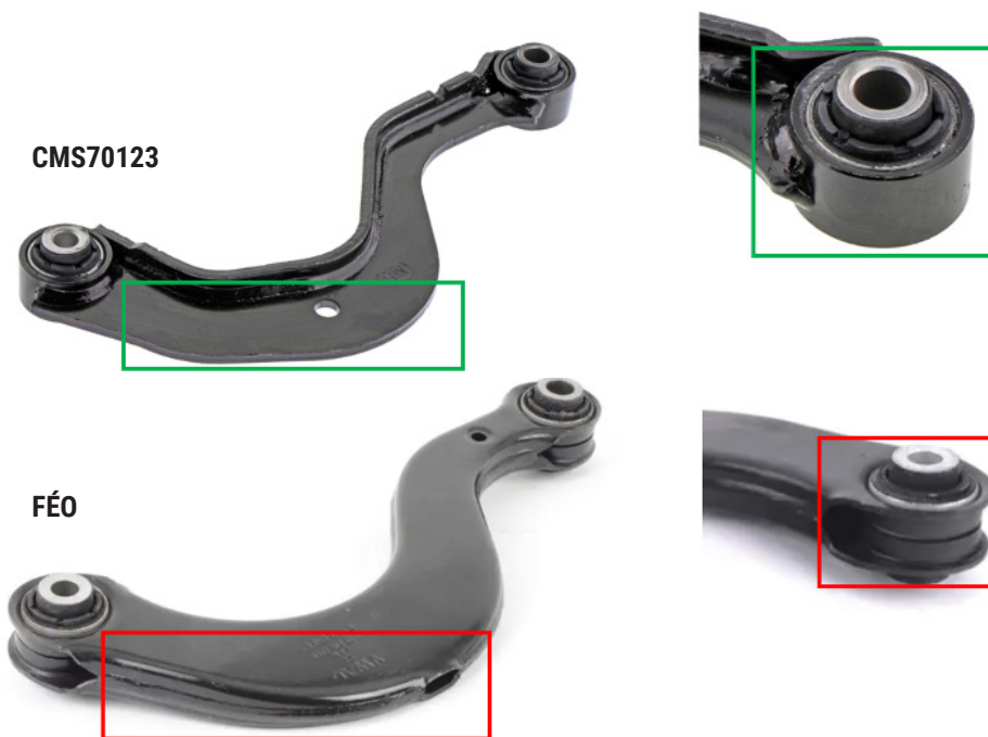
Figure 1. Bras de suspension supérieur arrière Mevotech Supreme CMS70123 avec une construction forgée solide et une meilleure rétention des bagues (haut) comparativement à la conception d'origine (bas)
