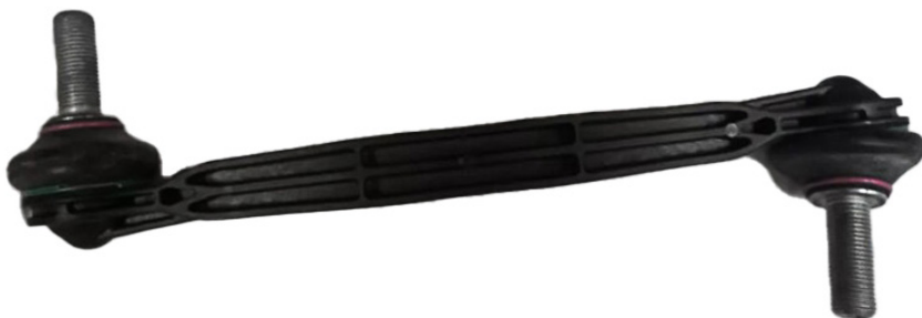
Figure 1. Pièce Mevotech Supreme MS258151 présentant une conception en acier massif avec paliers supérieurs et inférieurs en métal fritté autolubrifiants et graissables et une plus grande surface de contact entre le pivot de rotule et le palier ainsi que la quincaillerie incluse (haut) par rapport au corps en plastique de la pièce d'origine, au logement en plastique scellé et à la surface de contact réduite du pivot à rotule (bas)
