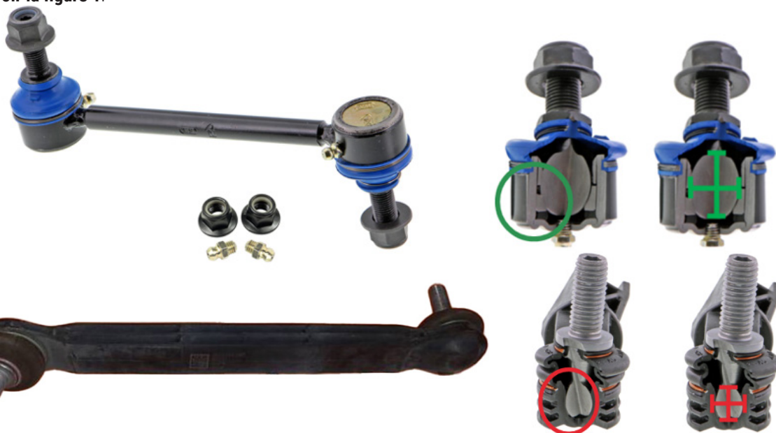
Figure 1. Pièce Mevotech Supreme MS258135 présentant une conception en acier massif avec paliers supérieurs et inférieurs en métal fritté autolubrifiants et graissables et une plus grande surface de contact entre le pivot de rotule et le palier ainsi que la quincaillerie incluse (haut) par rapport au corps en plastique de la pièce d'origine, au logement en plastique scellé et à la surface de contact réduite du pivot à rotule (bas)
