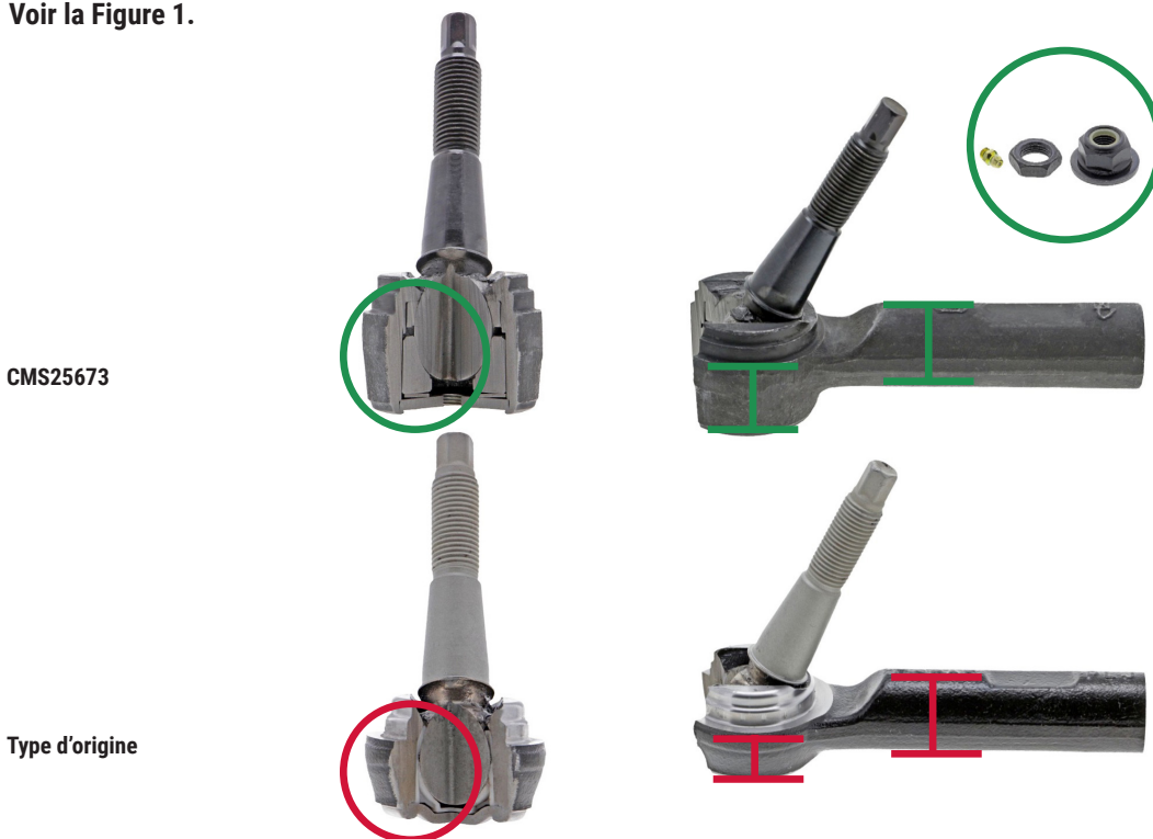
Figure 1. La biellette de direction extérieure avant Mevotech Supreme MS25673 avec profil de forgeage amélioré comprenant des paliers en métal fritté supérieur et inférieur autolubrifiants et graissables, et matériel inclus (haut) par rapport à la conception d'origine (bas).
