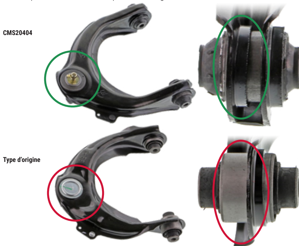
Figure 1. Bras de suspension Mevotech Supreme avec paliers en métal fritté graissables, estampage et profil de bague améliorés (en haut) comparativement au bras de suspension d'origine (en bas)
