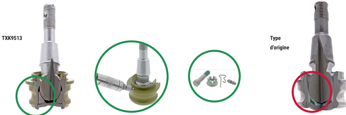
Figure 1. Mevotech TTX TXK9513 avec paliers en métal fritté autolubrifiants brevetés, raccord de graissage intégré et matériel inclus (gauche) vs joint à rotule d'origine avec palier en plastique scellé (droite)
