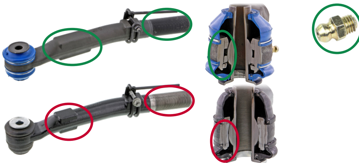
Figure 1. Embout de biellette de direction extérieur avant droit Mevotech Supreme MS40672 présentant un profil de forgeage amélioré, des paliers supérieurs et inférieurs en métal fritté autolubrifiants et graissables et un revêtement anticorrosion ainsi que la quincaillerie incluse (haut) par rapport à la pièce d'origine présentant un palier en plastique scellé, un profil de forgeage réduit et un embout fileté sans revêtement (bas).
