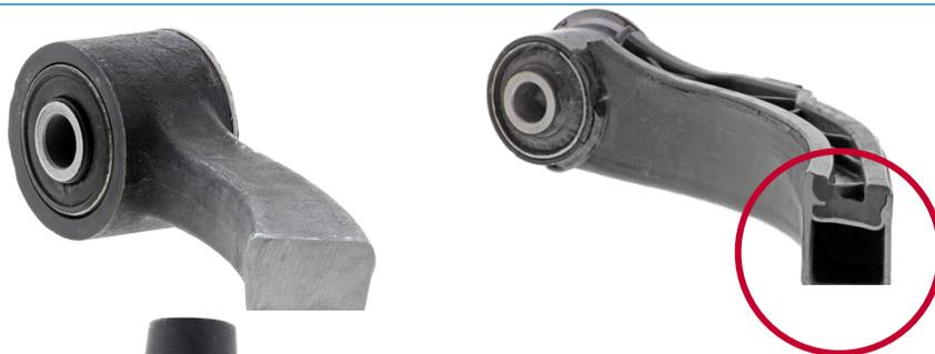
**Figure 2 :** Paliers supérieurs et inférieurs en métal fritté de Mevotech (à gauche) comparativement aux paliers en plastique de type « doublure » d'origine avec des espaces creux dans les principales zones de support (à droite)
