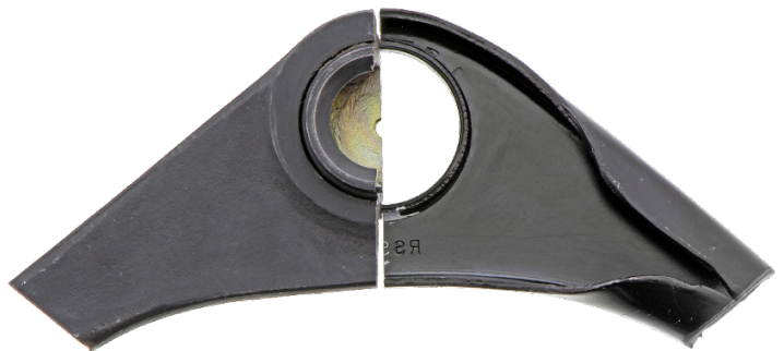
Figure 2 : Collet de bras de suspension Mevotech en acier forgé solide renforcé (à gauche) vs acier estampé d'origine (à droite)
