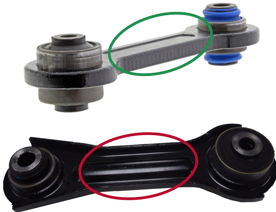
Figure 1. Bras latéral Mevotech Supreme CMS251251 avec profil forgé massif amélioré (en haut) comparativement à la conception en acier estampé plus mince d'origine (en bas).
