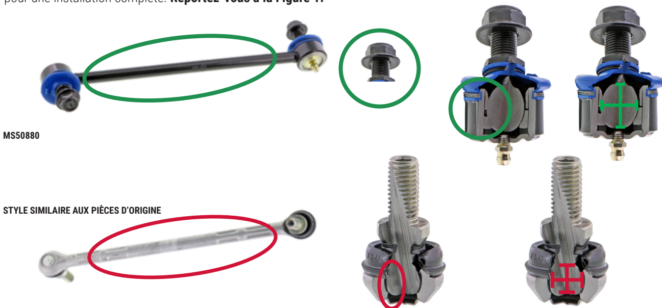
Figure 1. Embouts de barre stabilisatrice avant Mevotech Supreme MS50880 présentant une fabrication en acier massif avec un palier inférieur en métal fritté autolubrifiant et graissable et une plus grande surface de contact entre le pivot de rotule et le palier ainsi que la quincaillerie incluse (haut) par rapport à la pièce d'origine présentant un palier en plastique scellé, un corps en aluminium léger et une surface de contact réduite du pivot à rotule (bas).
