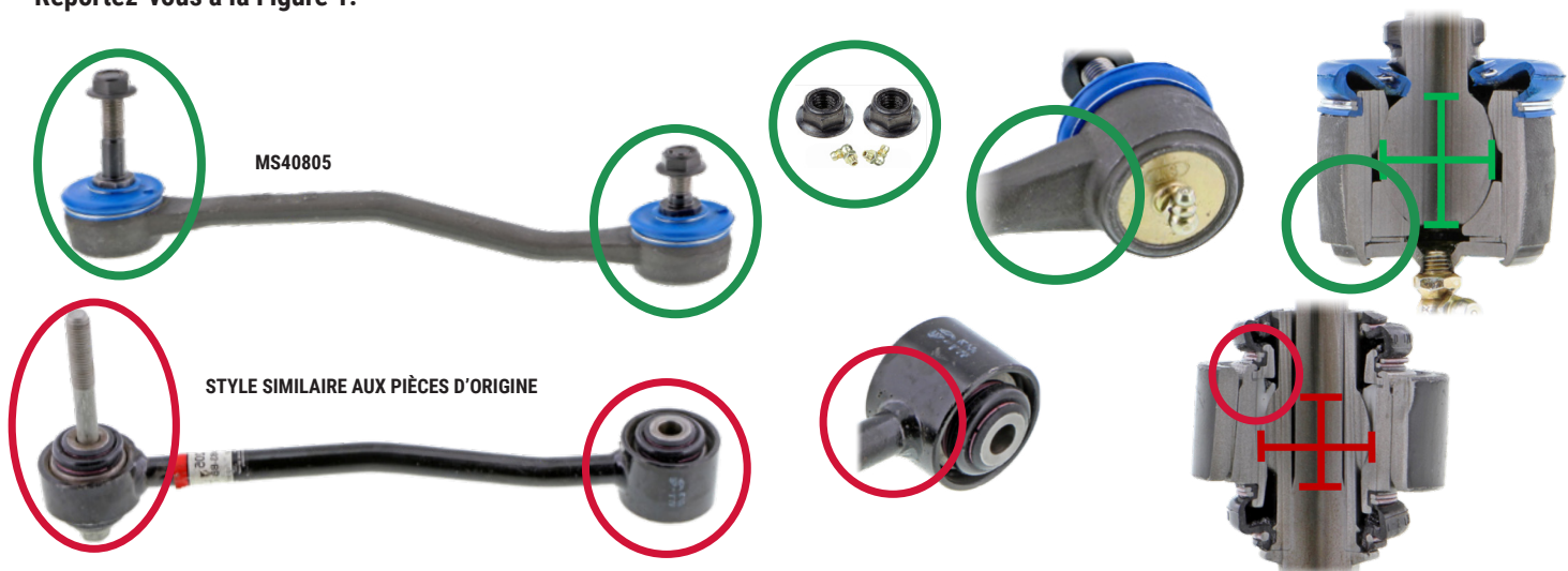
Figure 1. Embouts de barre stabilisatrice avant Mevotech Supreme MS40805 avec un forgeage monopièce en acier massif et des joints à rotule intégrés, présentant un palier inférieur en métal fritté autolubrifiant et graissable et une plus grande surface de contact entre le pivot de rotule et le palier ainsi que la quincaillerie incluse (haut) par rapport à la pièce d'origine présentant une conception à bague, un palier en plastique scellé, un raccord soudé et une surface de contact réduite du pivot à rotule (bas).
