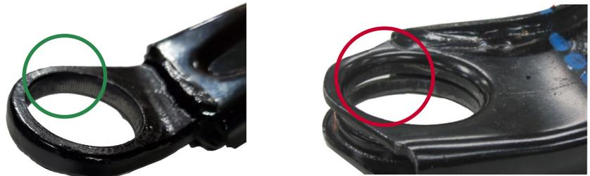
**Figure 2 :** Roulements en métal fritté graissables de Mevotech par rapport au roulement de plastique et au logement creux du fabricant d'origine (droite)
