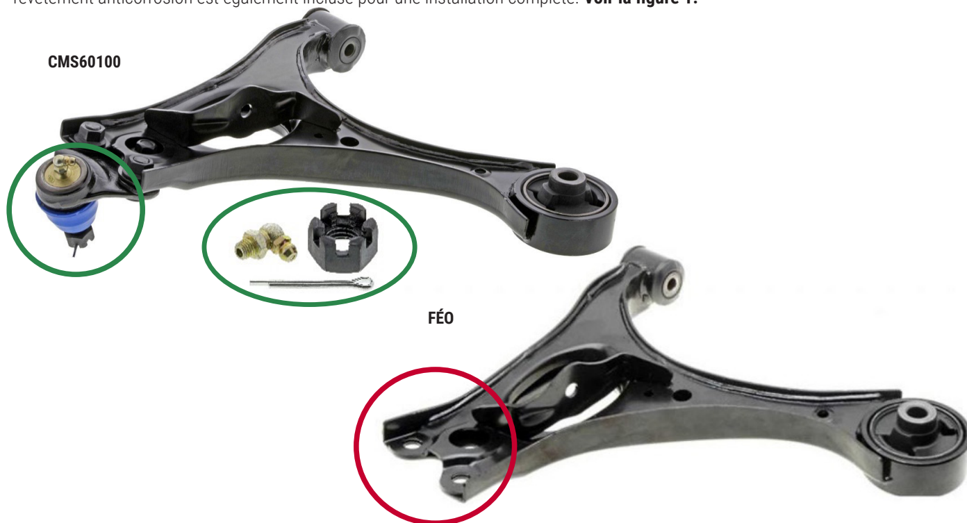
Figure 1. Ensemble de bras de suspension avant inférieur Mevotech Supreme CMS60100 avec joint à rotule prémonté doté d'un palier fritté autolubrifiant et graissable et quincaillerie (haut) par rapport au bras de suspension d'origine nu (bas)
