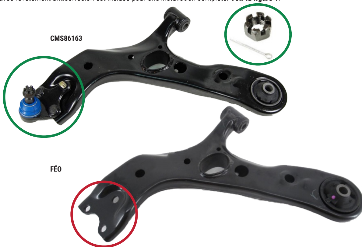
Figure 1. Bras de suspension inférieur avant Mevotech Supreme CMS86163 avec joint à rotule prémonté et quincaillerie (haut) comparativement au bras de suspension d'origine nu (bas)
