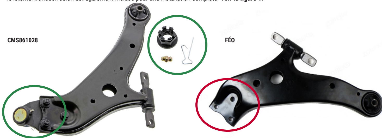
Figure 1. Ensemble de bras de suspension avant inférieur Mevotech Supreme CMS861028 avec joint à rotule prémonté doté d'un palier fritté autolubrifiant et graissable et quincaillerie (gauche) par rapport au bras de suspension d'origine nu (droite)
