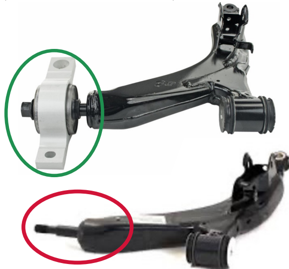
Figure 1. Bras de suspension Mevotech Supreme avec bague de conformité prémontée (en haut) comparativement au bras de suspension d'origine (en bas).
