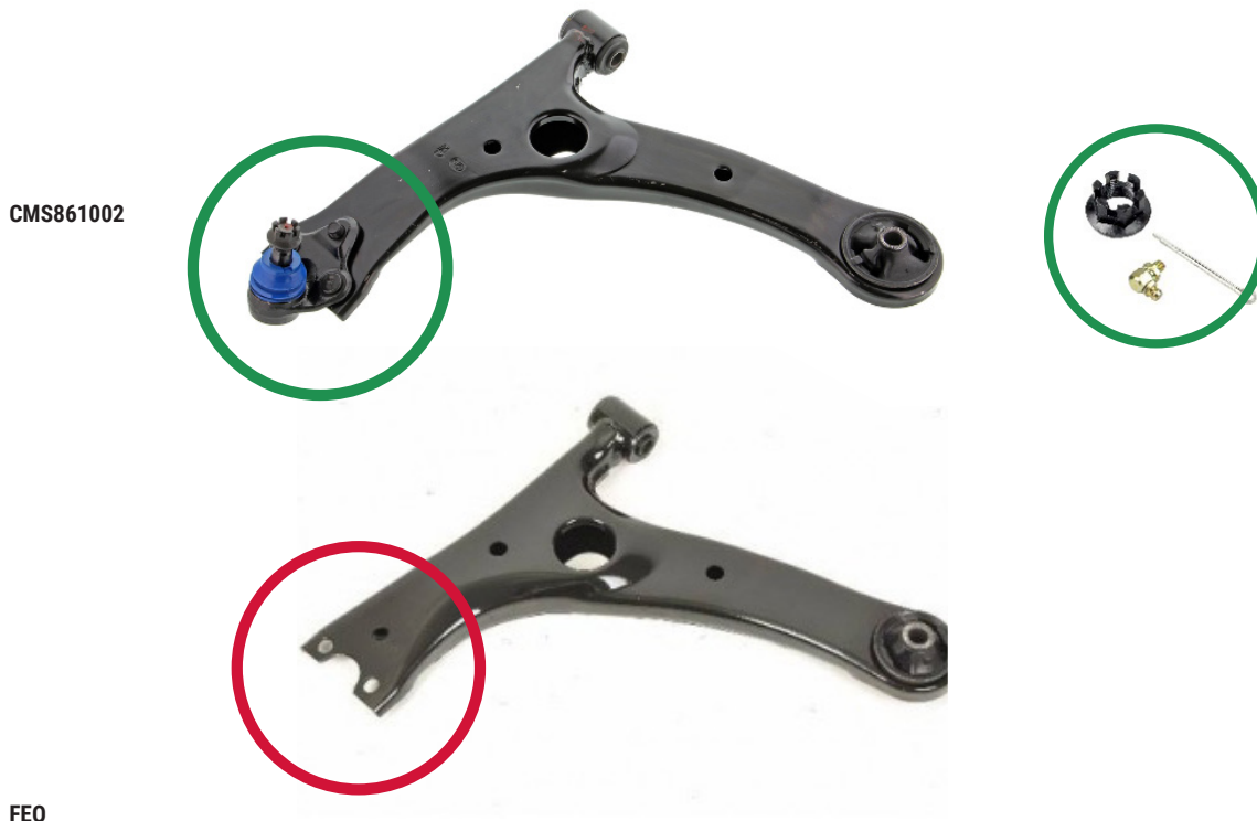
Figure 1. Bras de suspension Mevotech Supreme avec joint à rotule prémonté et matériel inclus (en haut) comparativement au bras de suspension d'origine nu (en bas)
