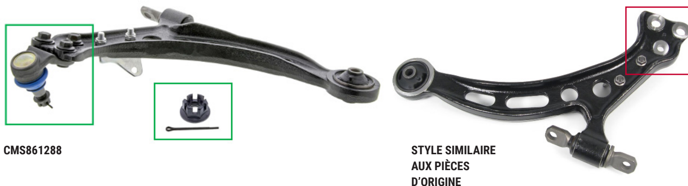
Figure 1. Ensemble de bras de suspension avant inférieur Mevotech Supreme CMS861288 avec joint à rotule prémonté et quincaillerie (gauche) par rapport au bras de suspension d'origine nu (droite)
