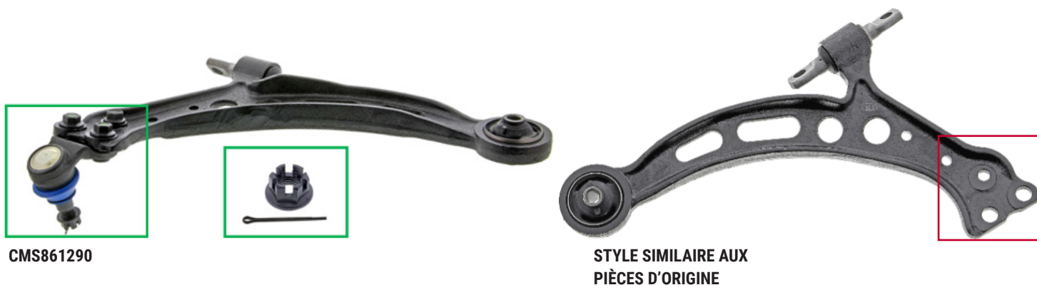
Figure 1. Ensemble de bras de suspension avant inférieur Mevotech Supreme CMS861290 avec joint à rotule prémonté et quincaillerie (gauche) par rapport au bras de suspension d'origine nu (droite)
